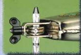
Die spezielle Halteklammer fixiert die Glocke sicher.
