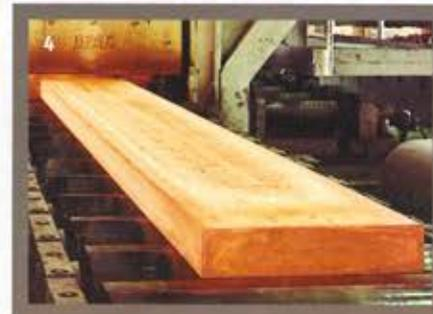
hen in mehreren aufeinanderfolgenden Arbeitsgängen perfekt verdichtete Bronzeplatten. Diese Platten werden nun im Kaltwalzverfahren zu Rohlingen von unterschiedlicher Materialstärke verarbeitet. Aus diesen Rohlingen werden dann Ronden mit unterschiedlichen Durchmessern ausgeschnitten und zur Weiterverarbeitung an die Meinl Cymbal Schmiede geliefert.
